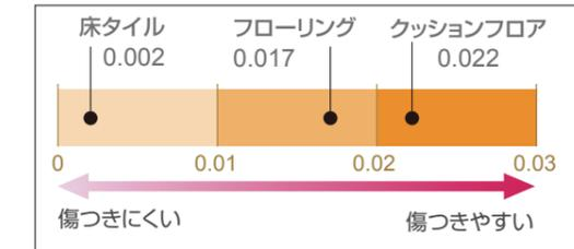
試験体表面を摩擦紙でこすり、摩擦した量を測定します。JIS K6902に準拠 (単位: g/100回転)
